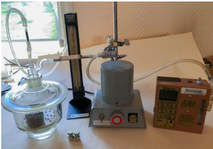
Figur 1. Mätuppställning för kammarmetoden med uttaget prov.
